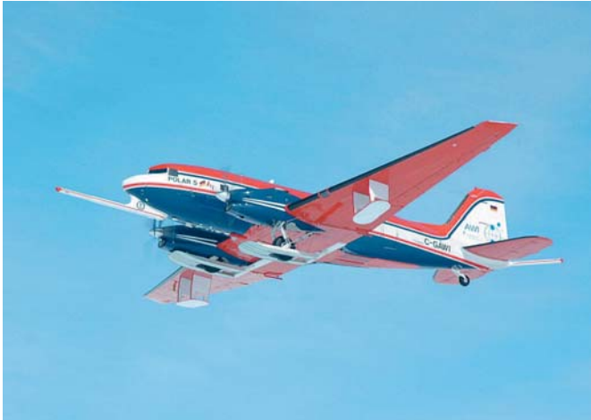
Abb. 2: Polar 5 mit geophysikalischer Instrumentierung nach dem Start. Unter den Tragflächen sind deutlich die Antennen der EMR-Apparatur zur Bestimmung der Eisdicken sowie vorn und am Heck des Flugzeugs die Ausleger für die Messung des Erdmagnetfeldes zu erkennen.
