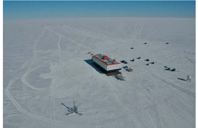
Abb. 6: Umgebung der Neumayer-Station III aus Nordost gesehen, getrennt vom Stationsgebäude sind das Windkraftwerk und die Antenne für die Satelliten-Standleitung aufgebaut. Etwa 1,5 km südlich befinden sich das Spurenstoff-Observatorium und das Magnetik-Observatorium. Südwestlich in etwa 3,5 km Entfernung ist das Infraschall-Array verlegt (Foto: U. Cieluch, AWI).
